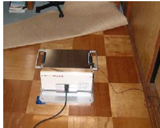
写真-1 小型水平起振器の設置状況
