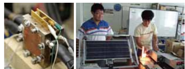
燃料電池セルの製作と性能評価(左)と光センサーによる姿勢制御機能を搭載した太陽光を追いかける自走式太陽光パネル
