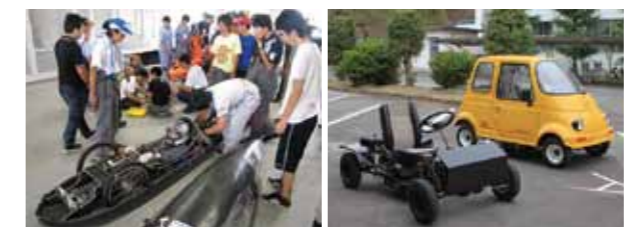
電池パワー(単3電池×40本)でコースを2周(11.6km)する省エネルギーカー(左)と電気自動車の改良製作
