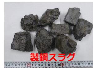
本研究は鉄鋼スラグのうち転炉系製鋼スラグを利用して藻場生育基盤を造成し、従来使用されている天然石や鉄鋼スラグ水和固化体と比較して、魚類などを含む藻場生態系形成の効果を明らかにすることを目的とし、神代漁業協同組合と協力して実施を行った。試験的に藻場生育基盤造成を行った山口県東部海域では、右図のとおり岸側に僅かに天然アマモ場が存在し、沖側に既存の漁礁が存在する。より一層の藻場による有用魚類等の増集効果を高めるために、それらと一体化する場所を造成場所として選定した。
