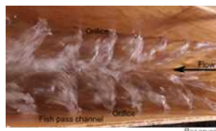
図-3 魚道部の流況
