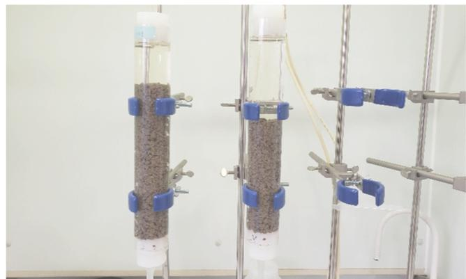
写真-2 水産加工排水のリン除去連続処理装置
