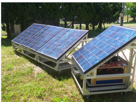
図1 太陽光パネル仮設置き台
