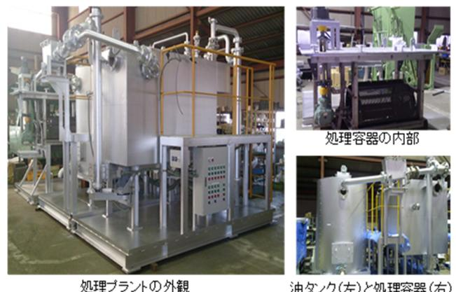
図2 廃線処理プラントの外観
