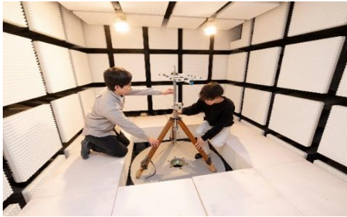
【共創空間】光電磁環境研究のための電波暗室 (熊本高専・佐世保高専)
