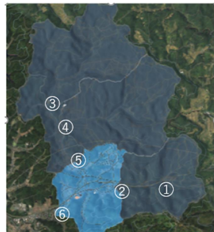
図-2 InfraWorksによる津幡川新道橋の流域算定
