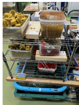
水質浄化装置 (傾斜土槽法)
