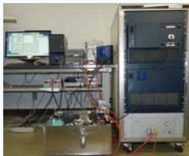
▲ステータコアの外力印加型鉄損測定装置
