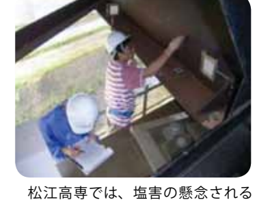
松江高専では、塩害の懸念される山陰地方などの地域では建設できない耐候性鋼橋梁の建設条件について、調査研究しています。
