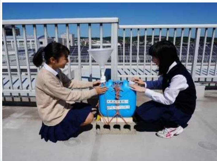
写真1 宇部高専屋上での降下ばいじん収集装置
