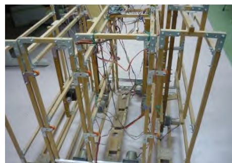
木の角材と金具を使った製作法
